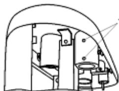
Рис. 8.32. Фиксация стойки светильника
